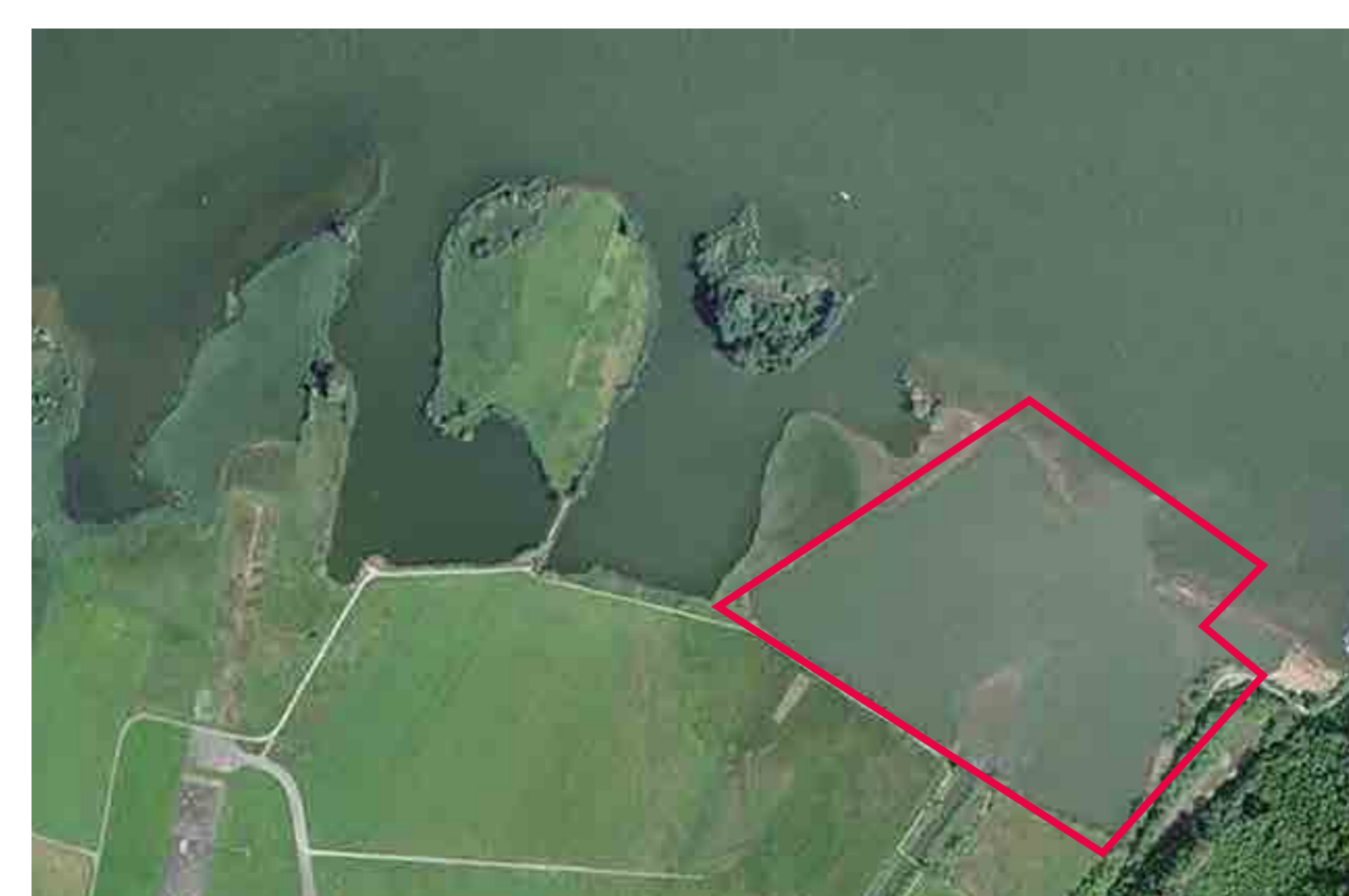
Luftbildaufnahme von 2016: Kiesabbau eingestellt; heutige Uferlinie mit Buchten und (Halb-) Inseln durch Kiesbaggerungen entstanden — Wasserbauprojekt Aufwertung Südufer Alpachersee; Bild: map.geo.admin.ch
