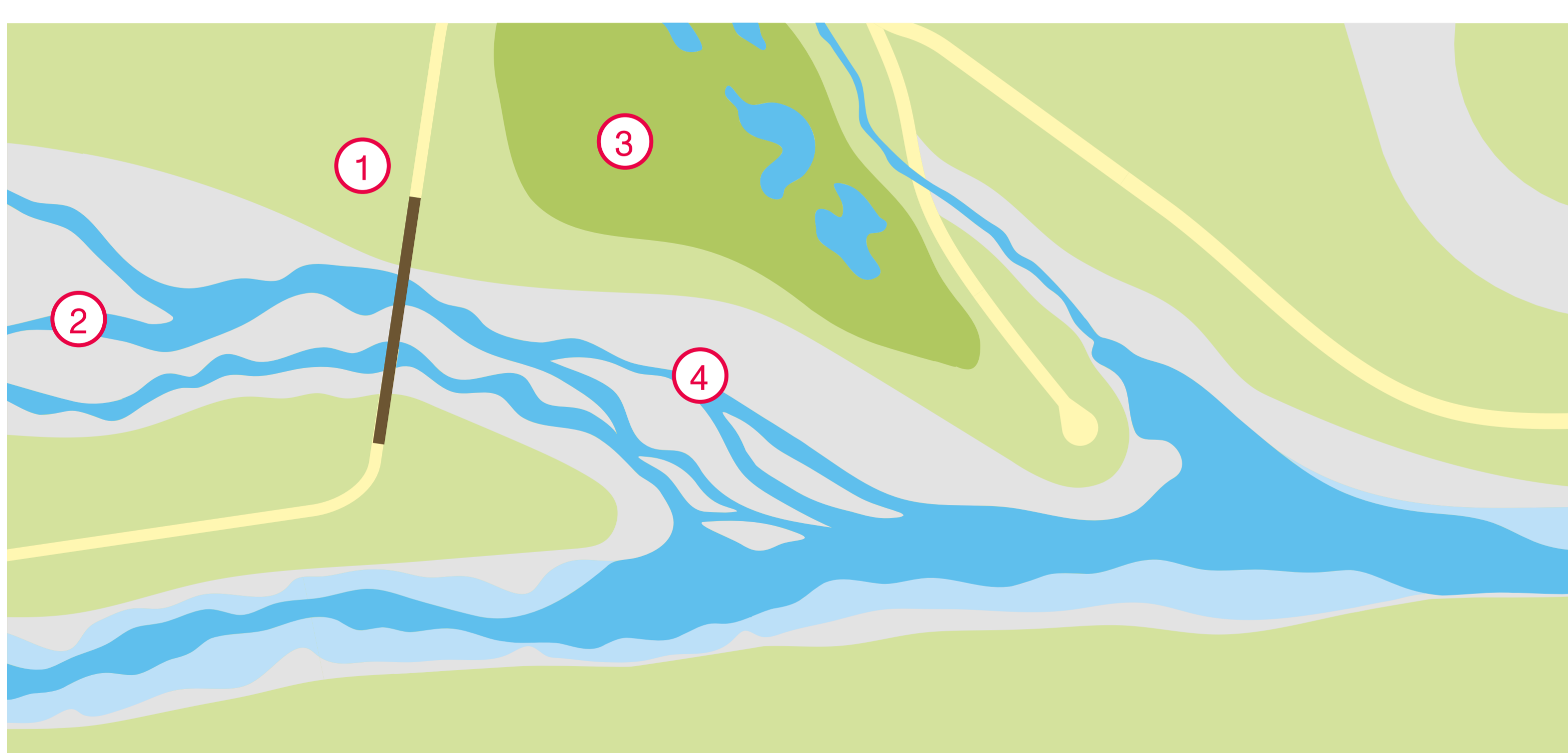
Abb. 2: Flusslauf ausgebaute Sarneraa mit Anbindung der Grossen Schliere
