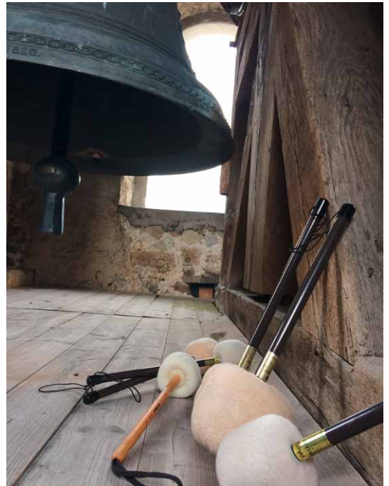
GLOCKENSTUHL UND VERSCHIEDENE SCHLÄGELTYPEN IM TEST
